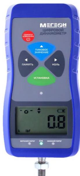
Рисунок 1 – Общий вид динамометра
